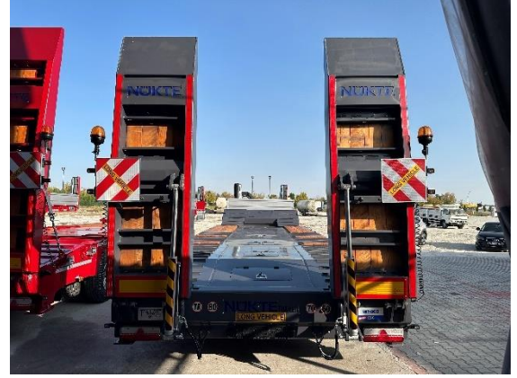
Yükleme Rampası (Kapalı)
